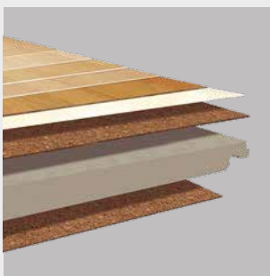
Bevonattal ellátott Comfort* padló összetétele.
