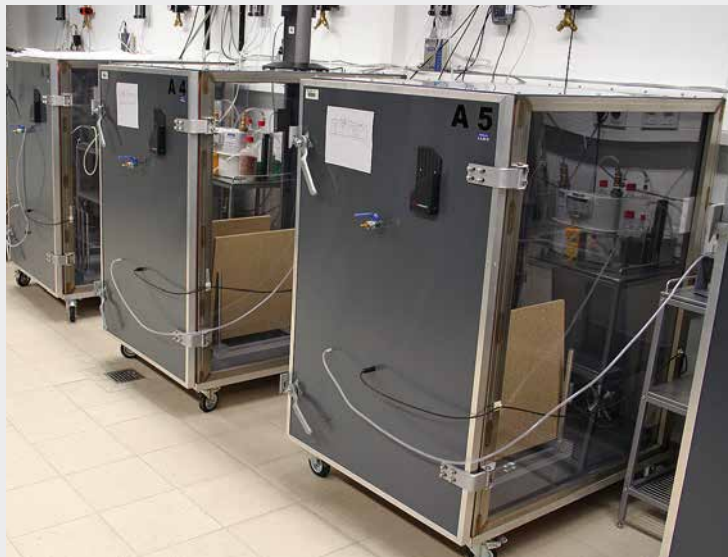
1m 3 -es légtérű vizsgálófülke a WKI Fraunhofer Intézetben.
