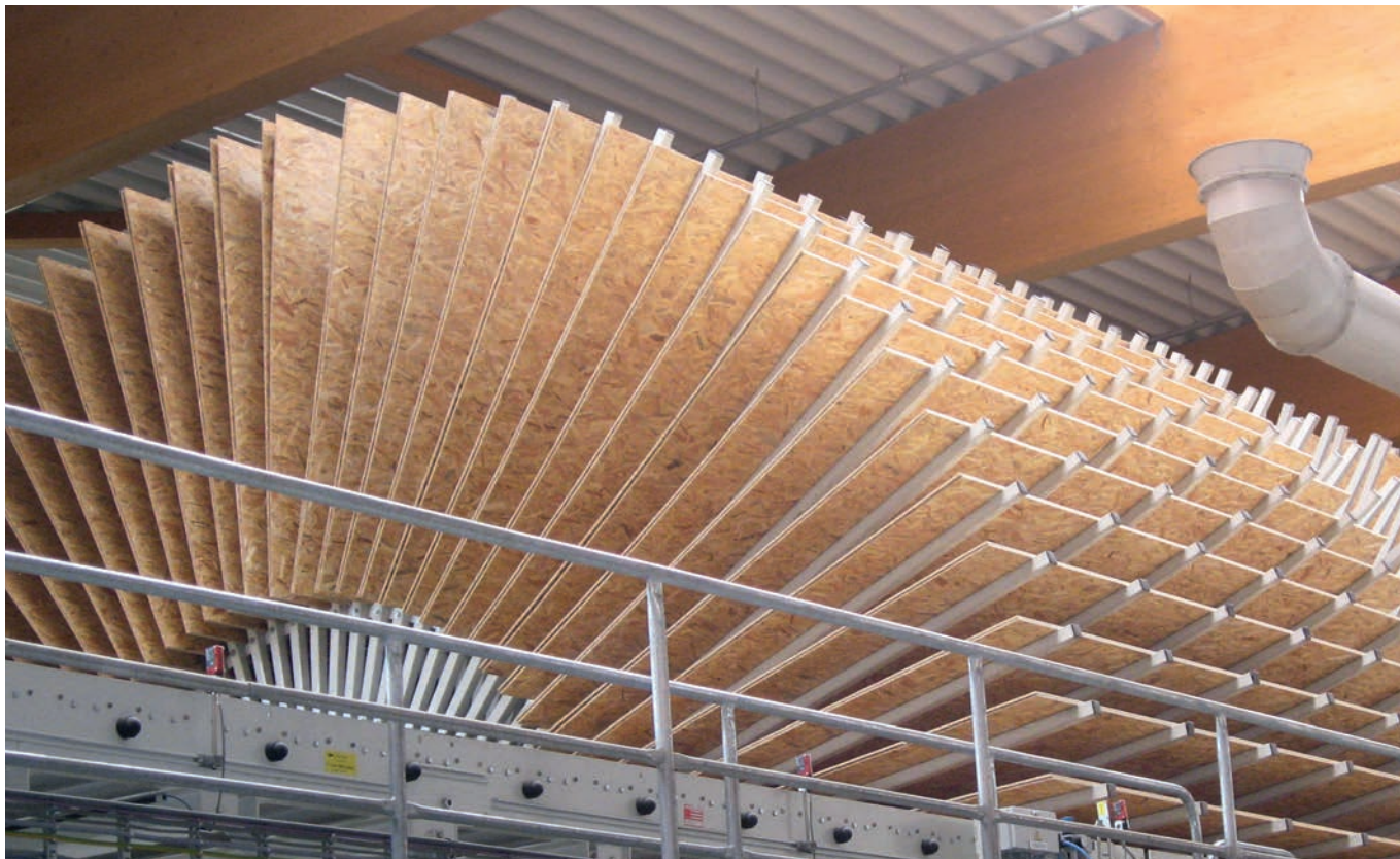
Kiváló minőség szabványok: OSB-lapok a „cooling star” forgógységében az EGGER üzemben.
