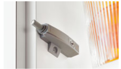
1b A TIP-ON egység a szekrény belsejébe adapterlemez segítségével (egyenes vagy keresztalakú) is beszerelhető.
